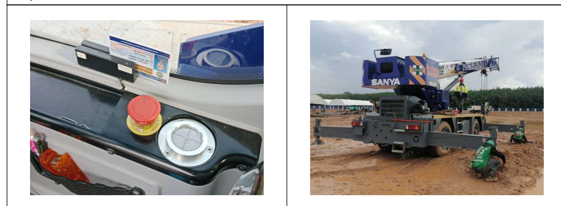
รูปที่ 30 สวิตช์หยุดการทำงานของปั้นจั่น
