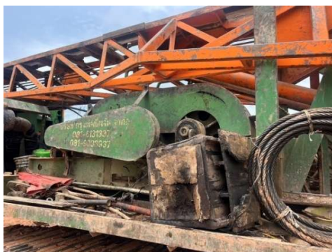
รูปที่ 32 ติดตั้งตะแกรงหรือที่ครอบปิดคลุมส่วนหมุนระบบส่งถ่ายกำลังป้องกันอุบัติเหตุของพนักงาน
